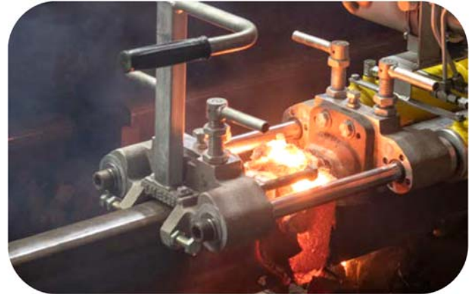
Cisailage de l'excédent de matière de la soudure
